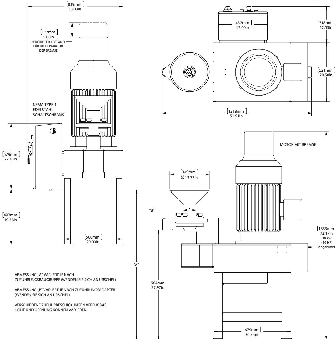
\* Die Höhe kann bei Motoren mit 30 und 15 Umdrehungen von der angegebenen Abmessung abweichen.
