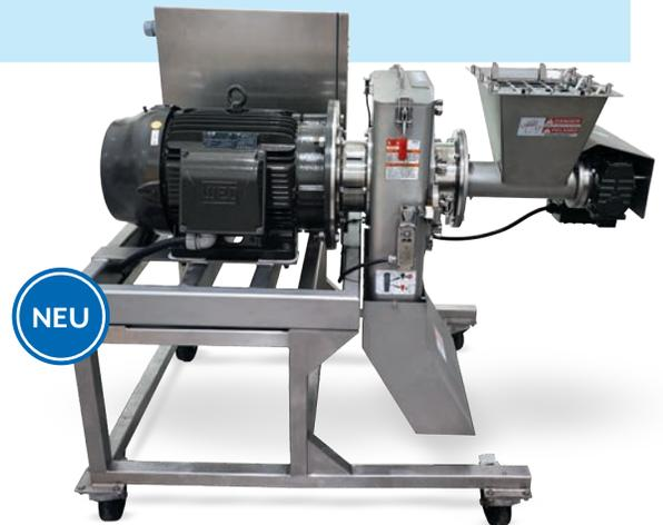
*(Die Maschine ist mit einem optionalen Edelstahlrahmen und einer Erweiterung des Auslauftrichters abgebildet).*
