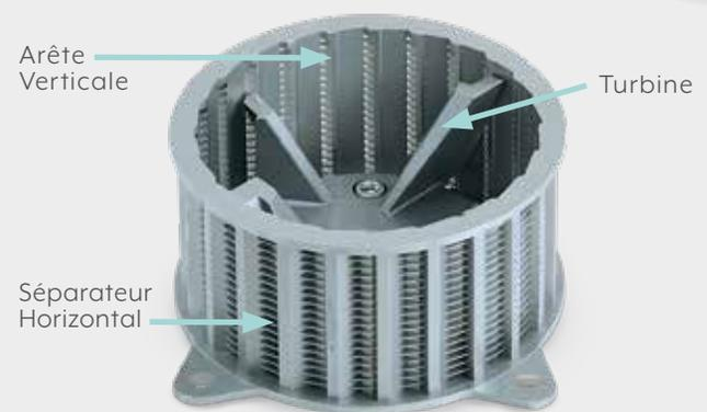
Le processeur Comitrol utilise le principe du cisaillement différentiel afin d'assurer un broyage d'une grande efficacité en faisant tourner le produit à des vitesses de rotation élevées à l'intérieur de la tête de coupe.
