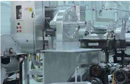
Le modèle 9300 est utilisé pour broyer des fruits et des légumes en une fine purée pour la production d'aliments pour bébés.
