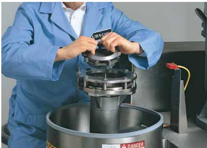
Les turbines et les têtes de Microcoupe se changent aisément pour passer à d'autres applications, au nettoyage ou à l'entretien.
