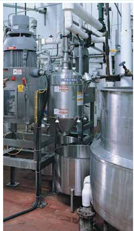
Un broyage uniforme de la peau de volaille est obtenu au moyen de deux modèles 1700 pour la production de concentrés pour potage.
