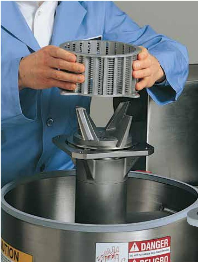
Les têtes de coupe et les turbines se changent aisément pour passer à d'autres applications, au nettoyage ou à l'entretien.
