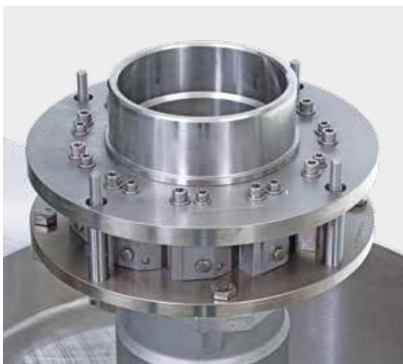
La tête de tranchage est une version miniaturisée de précision des autres trancheurs centrifuges d'Urschel. Elle consiste en un anneau composé de onze coupeurs fixes maintenus en place par des porte-couteaux réglables. La force centrifuge créée par la turbine en rotation plaque le produit contre la surface intérieure des porte-couteaux, ce qui permet la production de tranches uniformes au niveau de chaque couteau.
