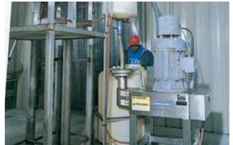
Des particules uniformes de poivrons sont produites au cours d'une opération de broyage en deux étapes à l'aide de deux modèles 1500.
