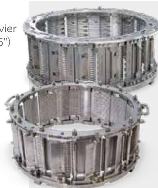
Die MicroAdjustable® SH-14 & SL-14 Schneidköpfe bieten eine verbesserte Leistung mit 14 Schneidstationen im Vergleich zu den standardmäßigen 8 Schneidstationen. Das innovative Design ermöglicht eine schnelle und präzise Einstellung, mit verbesserten Hygieneeigenschaften, sowie daraus resultierenden Zeit- und Arbeitszeiteinsparungen. Das neue SlideLocc™ Klemmsystem beschleunigt und vereinfacht den Messerwechsel und erfordert nur wenige Werkzeuge.
