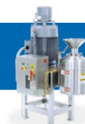
Comitrol1700型设备可装配三种不同的切割刀头。推荐用于可自流动或半干燥的产品应用。可选配集尘装置用于粉尘,粉末类的产品应用。可用微切刀头生产极小尺寸颗粒的产品。设备电机功率为15 HP (11.2 kW), 30 HP (22.4 kW)或 40 HP (30 kW)。
