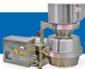
CC型切片机允许的最大产品进料尺寸可达4" (101.6 mm)。设备配备2 HP (1.5 kW), 5 HP (3.7 kW)或 10 HP (7.5 kW)电机。通过离心力切出尺寸均匀,形状优美的片,丝产品。
