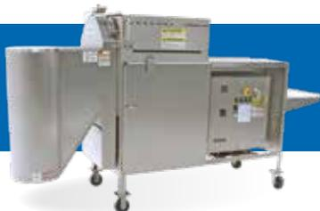
Dieser Bandschneider verarbeitet feste Produkte im Durchmesser bis 101,6 mm (4") und blättrige, komprimierbare Produkte mit einem Durchmesser von bis zu 152,4 mm (6"). Der E TranSlicer verfügt über eine kontinuierliche Leistung im Dauerbetrieb. Ein optionaler Niederhalter (feststehend oder angetrieben) in Verbindung mit unterschiedlichen Zufuhrbändern optimiert die Produktzufuhr.
