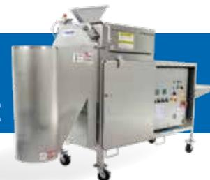
Durch das Nachrüsten der ETRS Bandschneidemaschine ist innerhalb von 10 Minuten auch ein Schrägschnitt möglich. Die manuelle Beschickung des Produktes erfolgt über die obere Zuführung direkt zum Messerrad. Der Durchmesser des zugeführten Produktes sollte 63,5 mm (2.5") nicht überschreiten.
