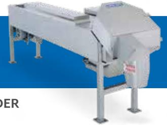
Das Urschel Modell OC wird speziell für die Herstellung von Schrägschnittscheiben aus länglichen Produkten verwendet. Die Maschine schneidet in einem 30-Grad-Winkel entlang der Längsachse des Produkts. Dadurch sehen die entstehenden Scheiben völlig anders (oval) aus als bei einem Standard-Querschnitt (rund). Es wird Scheibe für Scheibe nacheinander geschritten, wodurch ein Zerdrücken des Produkts vermieden wird.
