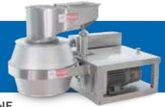
Gitterschnitte sind eine sehr spezielle Anwendung. Daher ist eine optimale Produktzufuhr unabdingbar, um ein schönes Schnittergebnis und eine kontinuierliche Produktion zu gewährleisten. Temperierte, hochwertige ovale oder runde Kartoffeln mit einer Größe von 51 – 102 mm (2 – 4") sind am besten für diesen Schnitt geeignet.
