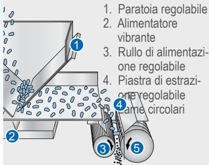
Il Modello N riduce in granuli frutta secca con guscio, biscotti e cracker e scarifica frutta congelata o disidratata. Gli elementi regolabili (paratoia, rullo di alimentazione e piastra di estrazione) permettono di accogliere prodotti di dimensioni variabili. Tagliando il prodotto invece di pestarlo o spaccarlo, la macchina limita la produzione di residui e permette di aderire maggiormente alle specifiche attese.
