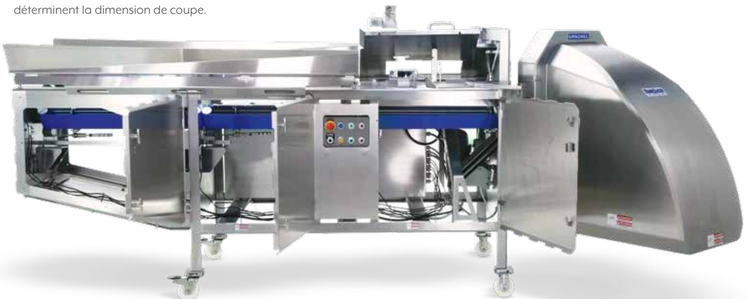
La coupeuse **TranSlicer® 2510** est le précurseur du nouveau modèle 2520. Les deux machines offrent les mêmes styles de roues de coupe de 635 mm (25"). Pour s'adapter aux différents produits, les clients peuvent choisir entre différentes configurations de bande d'alimentation : bandes primaires uniquement, bandes primaires et secondaires ou bandes primaires longues. La machine utilise un variateur de fréquence (VFD).
