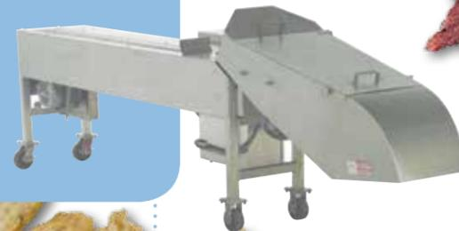
El Urschel Modelo OC ofrece una amplia selección de rodajas en ángulo. Este tipo de corte es popular en la producción de plátano, yuca y rodajas de pan. La máquina ofrece un funcionamiento continuo para una producción ininterrumpida. El tamaño máximo del producto de entrada es de 2.5" (63.5 mm) de ancho o diámetro.
