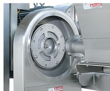
Unidad de corte con la caja de corte retirada. (se ilustra solamente para ilustración)
