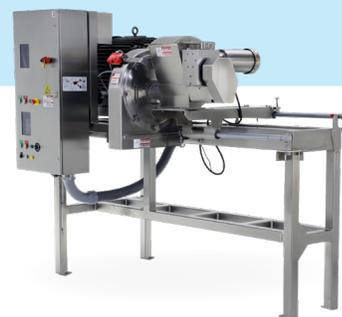
O moinho Comitrol® Processor Modelo 9300, está equipado com uma Cabeça de Microcorte de 12" (304,8 mm) de diâmetro e está disponível em duas versões; uma em que é alimentado por bomba e outra por um semfim de alimentação. A cabeça de Microcorte combinada com um motor potente, garante uma operação de elevada capacidade e precisão no que respeita à redução final do tamanho das partículas. O Modelo 9300, é recomendado para aplicações do tipo; suspensões de partículas, pastas ou líquidos.
