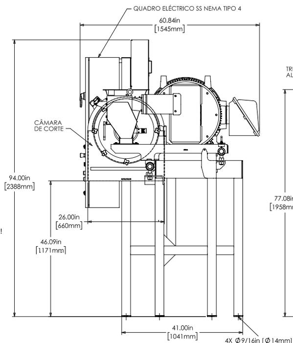
NOTA: A MÁQUINA DEVE ESTAR NIVELADA E FIXA AO PAVIMENTO
