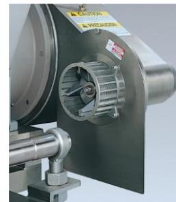
SCHNEIDEINHEIT MIT ENTFERNTER SCHNEIDKAMMERABDECKUNG
