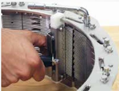
La configuration tranches plates comprend le mécanisme de serrage rapide, l'ouverture positive des lames et des couteaux à poignée.
