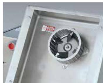
Unidade de corte com cobertura de corte removida (Para ilustração)
