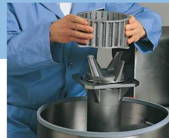
As cabeças de corte e o impulsor, são muito simples de substituir facilitando outras aplicações, limpeza ou manutenção.
