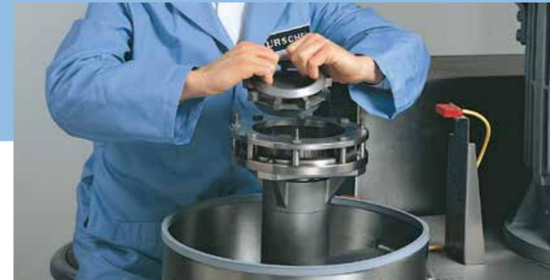
Os impulsores e as Cabeças de Microcorte, são facilmente substituídos, permitindo outras aplicações, limpeza ou manutenção.
