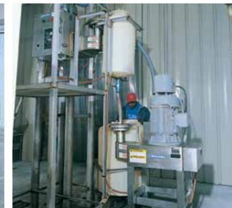
Os pimentos são transformados uniformemente numa operação de moagem em dois estágios, usando duas unidades do modelo 1500.
