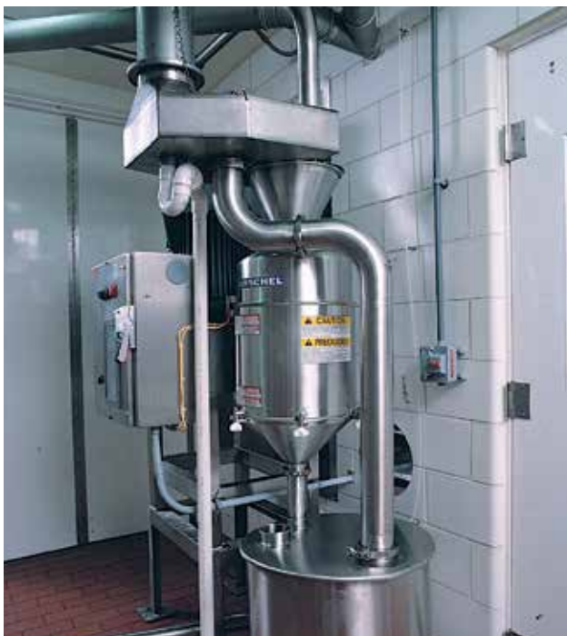
Skóra z drobiu jest wstępnie krojona przez model 1700, wyposażony w głowicę tnącą.
