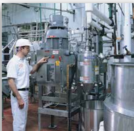
Masę ze skóry drobiowej o bardzo gładkiej konsystencji uzyskuje się przez dwustopniowe mielenie z wykorzystaniem dwóch modeli 1700 wyposażonych w głowice mikrotnące.
