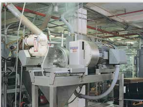
Produkcja gładkiego masła orzechowego dokonuje się za jednym przejściem produktu przez Model 9300 wyposażony w podajnik ślimakowy.
