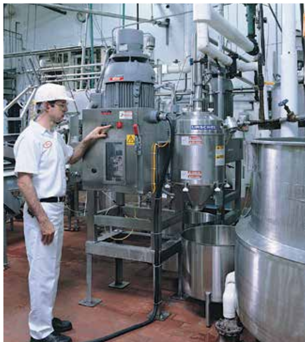
Jednorodne mielenie skóry z drobiu do produkcji kostek rosółowych jest realizowane dwustopniowo, przez dwa rozdrabniacze model 1700.
