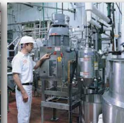
Auf zwei mit Mikroschneidköpfen ausgestatteten Einheiten des Modell 1700 wird Geflügelhaut in zwei Stufen zu einer cremigen Masse verarbeitet.
