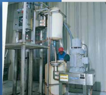
Mit zwei Einheiten des Modells 1500 werden Paprikaschoten in zwei Stufen gleichmäßig zerkleinert.
