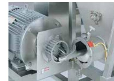
Schneideinheit ohne Abdeckung (zu Illustrationszwecken)
