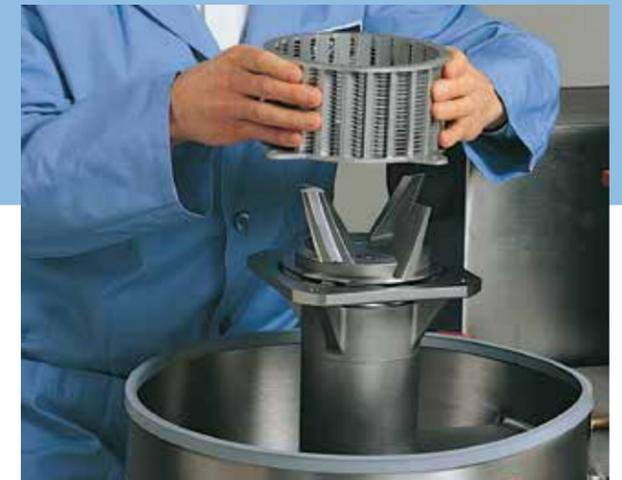
Schneidköpfe und Rotor lassen sich für andere Anwendungen oder Reinigungs- und Wartungsarbeiten leicht austauschen.
