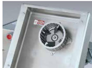
Schneideinheit mit abgenommener Schneidabdeckung (zu Illustrationszwecken)
