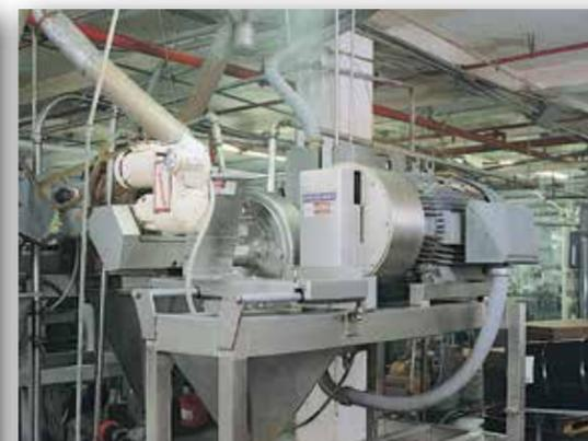
Das Modell 9300 mit Beschickungseinheit verarbeitet Erdnüsse in einem Durchgang zu glatter, cremiger Erdnussbutter.
