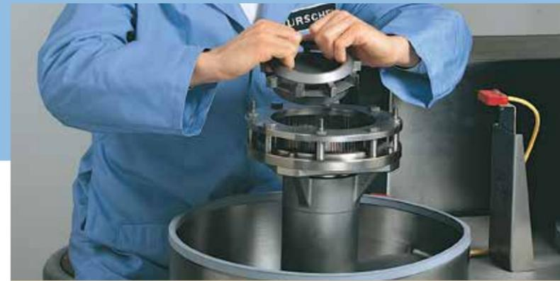
Rotoren und Mikroschneidköpfe lassen sich für andere Anwendungen oder Reinigungs- und Wartungsarbeiten leicht austauschen.
