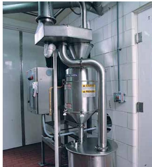
Geflügelhaut wird mit einem Modell 1700 mit Standard-Schneidkopf vorgeschnitten.
