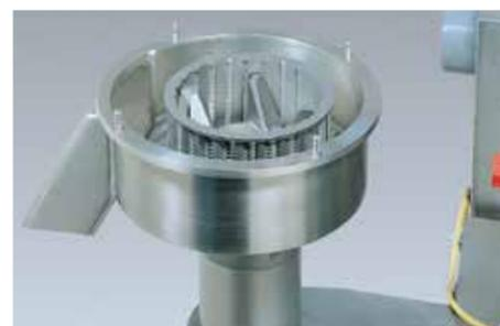
Schneideinheit ohne Abdeckung und Trichter (zu Illustrationszwecken)
