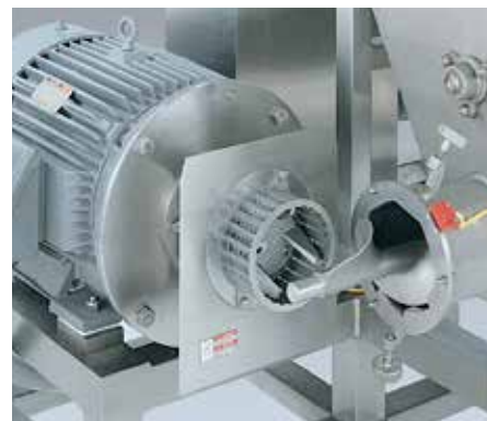
拆下外壳后的切割刀具 (如图所示)
