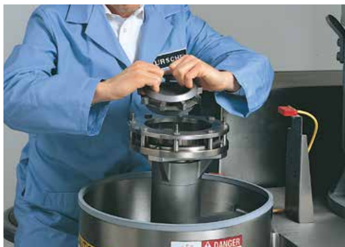
微切刀头和动刀拆装简便，易于清洗及维护
