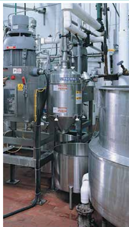
家禽皮通过两台1700型设备均匀研磨，用于生产汤底。
