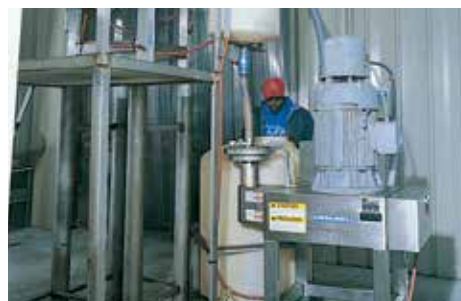
采用两台1500型以两步骤的研磨方式生产辣椒酱
