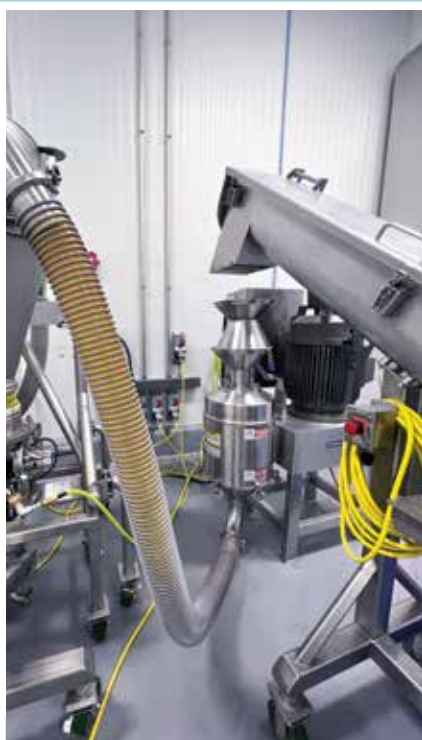
用于调味的脱水果蔬粉在配备HMI的1700型上进行加工。
