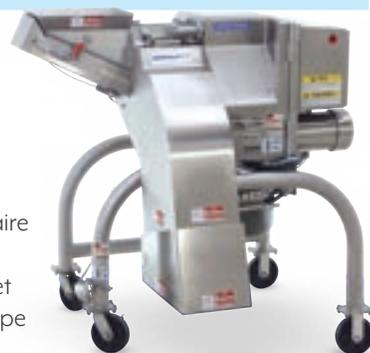
Le modèle Affinity accepte une grande variété de produits de formes et dimensions variées. La grande goulotte d'alimentation accepte des produits d'un diamètre maximum de 178 mm ou des produits longilignes pouvant aller jusqu'à 254 mm. Sa grande goulotte d'alimentation et son moteur puissant de 25 CV (18 kW) fournissent une capacité de production maximale.
