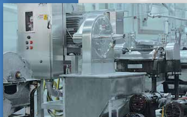
El Modelo 9300 se utiliza para moler frutas y vegetales en un fino puré para la producción de alimento para bebés.
