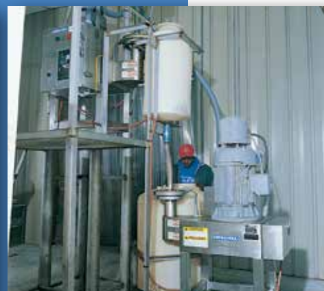
Uniforme producción de pimientos en una operación de dos etapas de molido, utilizando dos unidades Modelo 1500.
