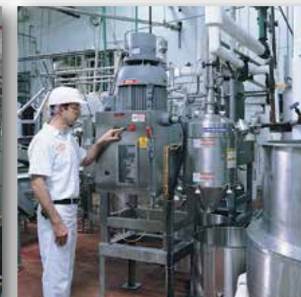
El molido de piel de aves producen una consistencia suave, utilizando dos Modelos 1700 equipados con cabezales de microcorte.
