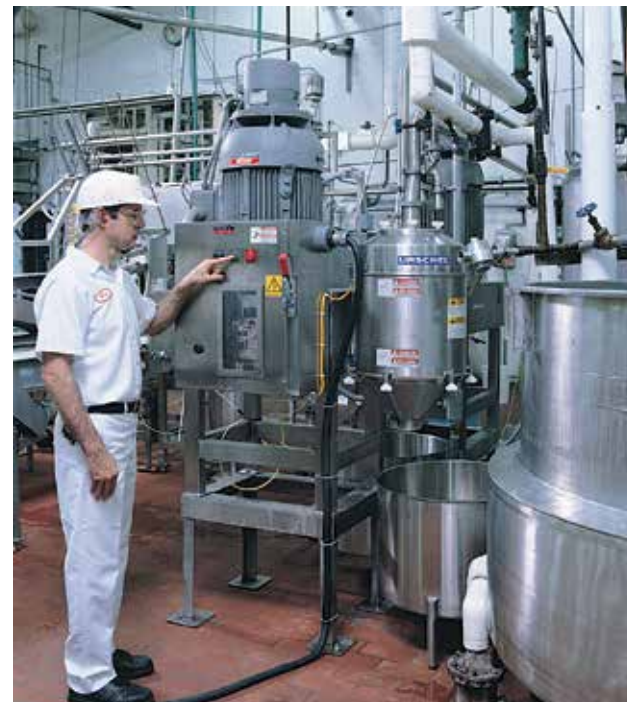
Se finaliza el molido uniforme de la piel de ave con dos Modelos 1700 para producir una base para sopa.
