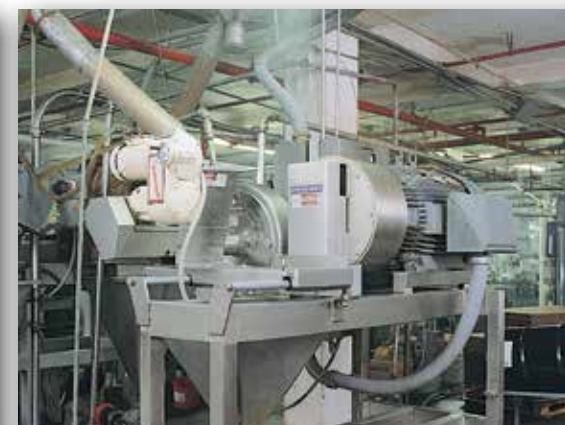
La producción de mantequilla de maní suave y cremosa, se lleva a cabo en una sola pasada a través del Modelo 9300 equipado con un alimentador.
