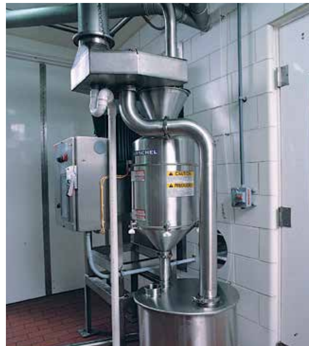
La piel de ave se pre-corta con un Modelo 1700 equipado con un cabezal de corte.
