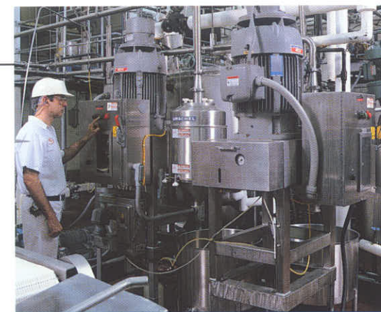
■ Με την άλεση δύο σταδίων δέρματος πουλερικών παράγεται ομοιογενές προϊόν. Η διεργασία γίνεται σε δύο Μοντέλα 1700 εξοπλισμένα με κεφαλές μικροκοπής.
