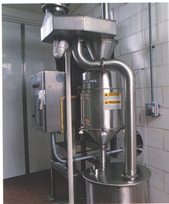
Ο προ-τεμαχισμός δέρματος πουλερικών γίνεται στο Μοντέλο 1700, εξοπλισμένο με κεφαλή κοπής.
