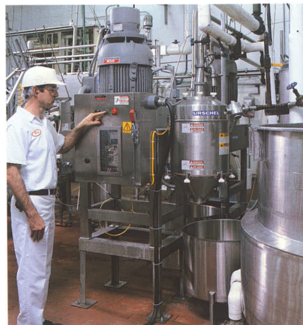
Η διεργασία ομοιόμορφης αλέσεως δέρματος πουλερικών για την παραγωγή βάσης για σούπα, ολοκληρώνεται σε δύο Μοντέλα 1700.
