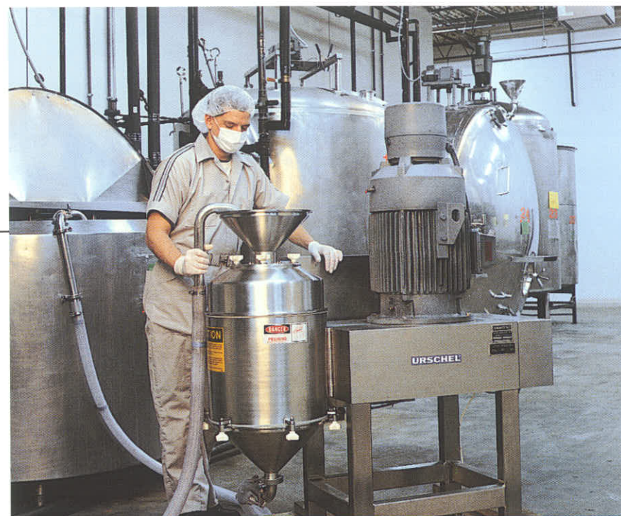
■ Στο Μοντέλο 1700 αλέθεται αλόη για χρήση σε διάφορα δερματολογικά προϊόντα.
