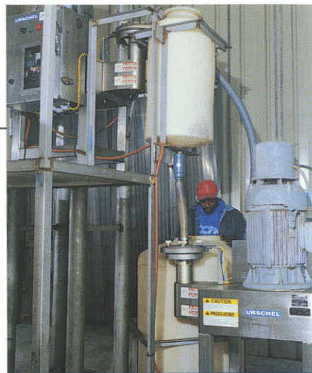
■ Ομοιόμορφη παραγωγή πιπεριάς με διεργασία δύο σταδίων, χρησιμοποιώντας δύο Μοντέλα 1500.
