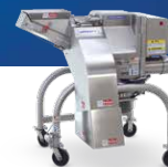
Coupeuse Affinity® avec convoyeur Usage intensif, 3-D avec convoyeur intégré, moteur de 25 CV (18 kW) + moteur de 5 CV (3,7 kW) pour l'arbre transversal + moteur de convoyeur d'entrée de 1/6 CV (0,12 kW)
