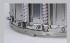
L'anneau inférieur autobloquant se monte sur le support de la tête de coupe du modèle CCX-D standard.
