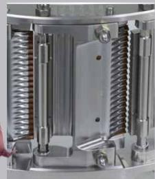
Le contre-couteau fléchit lorsque l'on tourne les tiges de réglage et permet d'effectuer des microréglages d'épaisseur du râpé.
